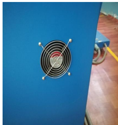
图 6-4 X 射线数字成像系统机械通风装置
